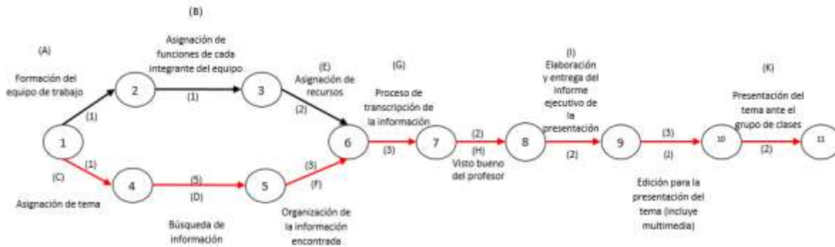
Figura 2.9. La ruta crítica es la que consume mayor tiempo para su logro; en este caso está formada con las actividades C, D, F, G, H, I, J, K, con un tiempo total de 21 horas.
