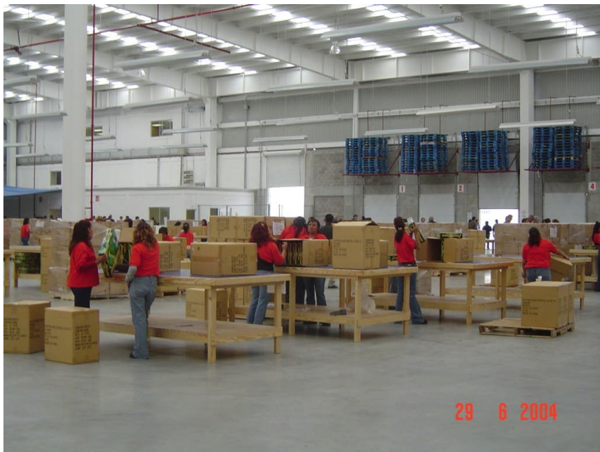
Figura 3.9. Zona de inspección (mesas de trabajo en un almacén), estas mesas pueden también apoyar el trabajo de algún proceso alternativo como empaque o desempaque de los bienes, nótese al extremo derecho, los andenes de recibo
