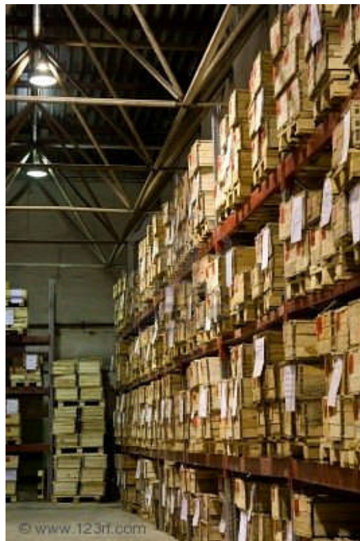
Figura 4.8. Estantería “pesada” nótese la disposición de las cajas sobre tarimas, en este caso la estiba debe realizarse por medio de montacargas
