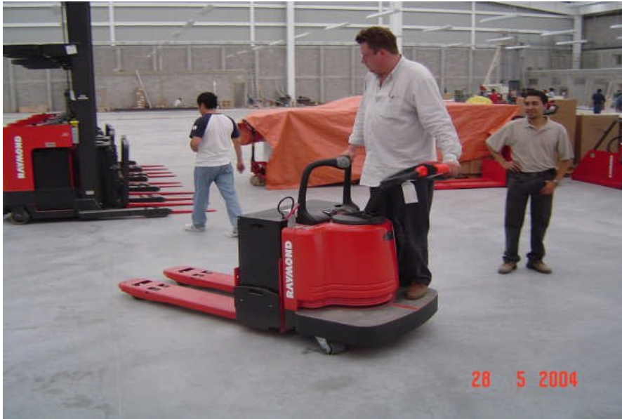
Figura 4.2 Patín eléctrico, puede notarse entre las “uñas” del mismo y el operador, la batería que suministra la energía para su tracción. 2
