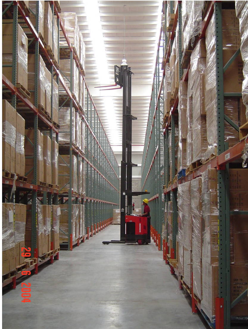
Figura.2.2. Vista de un almacén con mercancía paletizada en resguardo sobre los racks, y la colocación o salida de una tarima por medio de montacargas
